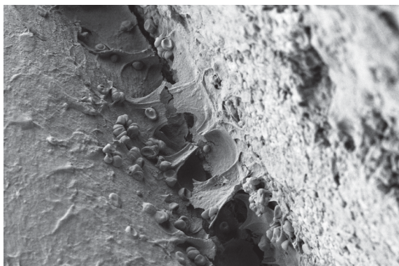
Рис. 6. СЭМ поверхности имплантата. Экспозиция 10 недель. Коммуникации в форме «песочных часов» между кортикальной пластинкой и имплантатом с ГАП-покрытием. Ув. \times 200
