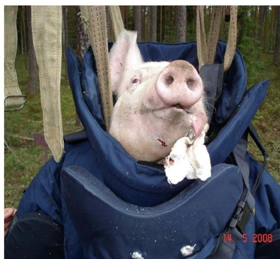
Рис. 2. Состояние взрывотехнического костюма и животного после первого эксперимента
