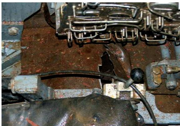
Рис. 2. Повреждение (разрыв) внутреннего металлического листа пола около места механика-водителя после подрыва под днищем двух ОФС
