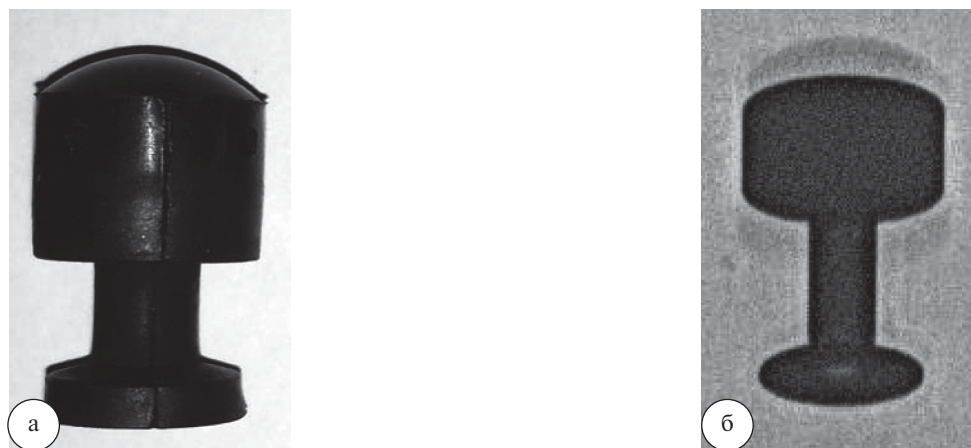
Рис. 2. Резиновая пуля калибра 18 45Т к пистолету «ОСА» ПБ-4-1 (а); б – её рентгенограмма
