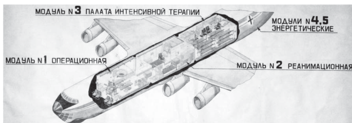
Рис. 9. Расположение медицинских модулей (операционного, реанимационного и палаты интенсивной терапии) на предыдущем варианте самолета Ил-76МД «Скальпель-МТ».
