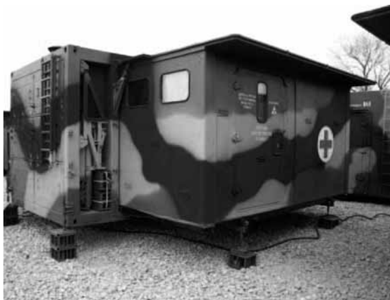
Рис. 1. Кузов-контейнер переменного объема раскладного типа (НПП «Проект-техника», Россия)
