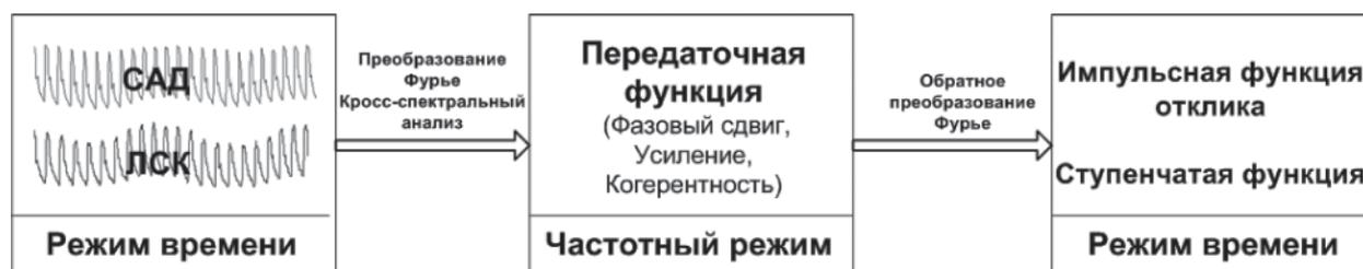
Рис. 6. Реализация импульсной функции отклика в режиме времени с помощью прямого и обратного преобразования САД и ЛСК
