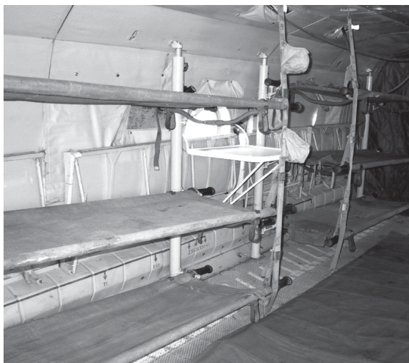
Рис. 1. Санитарное оборудование в грузовой кабине Ми-8МТВ-5
