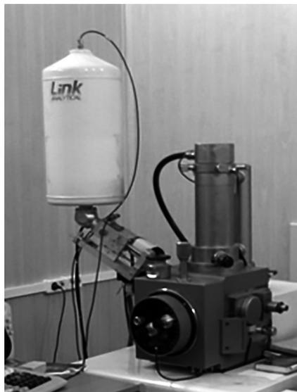
Рис. 1. Электронный микроскоп «АВТ-55»
