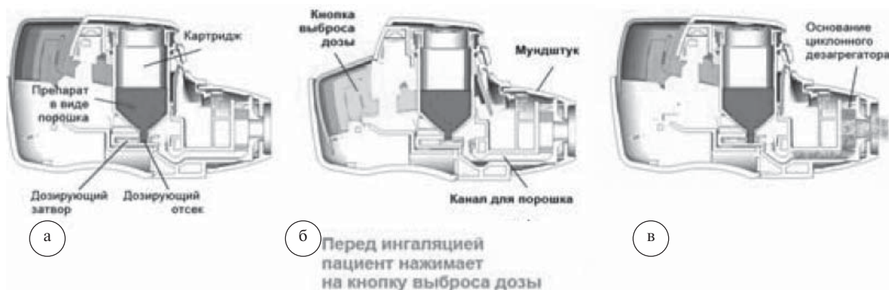
Рис. 12. Порядок дозирования лекарственного вещества в порошковых ингаляторах на примере аклидиния бромид (Бретарис® Дженуэйр®): а – исходное положение; б – загрузка отмеренной дозы; в – ингаляция отмеренной дозы
