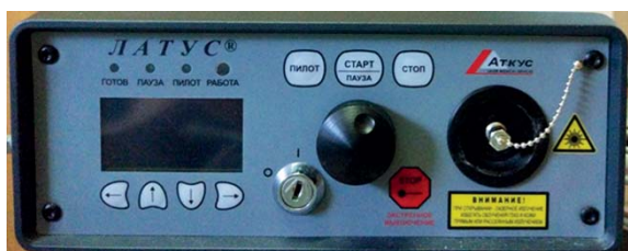
Рис. 4. Полупроводниковый лазер «Латус 2,5» (ООО «Полупроводниковые приборы» г. Санкт-Петербург)
