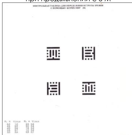
Рис. 7. Таблица штрих-миры, модифицированный опотип, рассчитанный для остроты зрения 1,0 при предъявлении с 5 м
